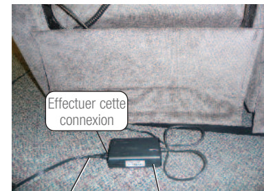
Cordon d'alimentation 120 volts Transformateur électrique
