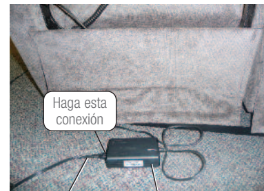
Cordón de 120 voltios Transformador de corriente
