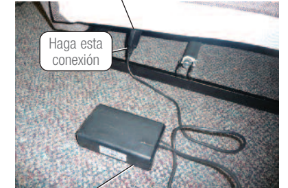
Transformador de corriente
