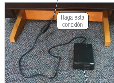
Transformador de corriente
