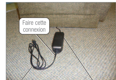
Cordon électrique de 120 volts Transformateur électrique
