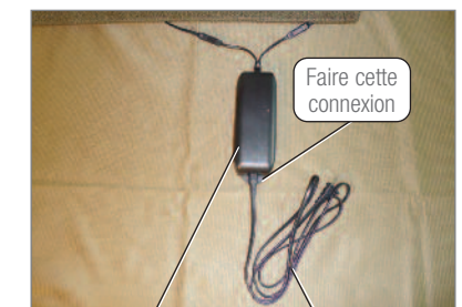
Transformateur électrique Cordon électrique de 120 volts
