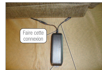
Transformateur électrique Petit câble en Y
